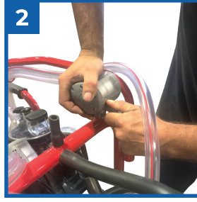
2 Pulsatörleri resimde gösterilen yerlere takınız.
