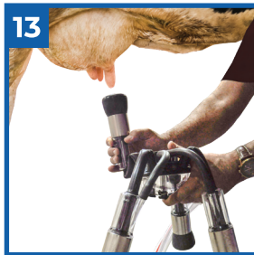
13 Memelikleri teker teker takarak sağıma başlayabilirsiniz. Vakumu korumak için memelikleri bükerek takınız.
