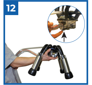
12 Sağım başlığını asılı olan yerden alarak resimdeki gibi ters çeviriniz ve küre mandalına basınız.
