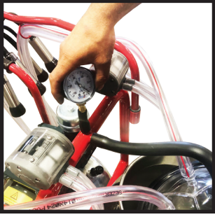
5-Vakum saatini ambalajından çıkartarak, resimde gösterildiği şekilde takınız.
