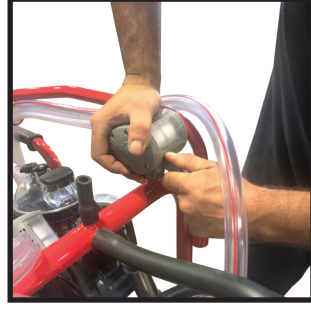
2-Pulsatörleri resimde gösterilen yerlere takınız.
